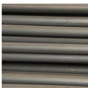
**Tondo liscio laminato a caldo per applicazioni strutturali\***, strutture metalliche composite e strutture cementizie composite, marcate CE, diametro 10-40mm, lunghezze variabili fino a 18m. I gradi acciaio prodotti nel 2022 sono: S275JR, S275J0, S275J2, S355JR, S355J0, S355J2, S355K2
