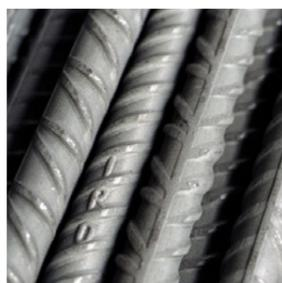
**Tondo nervato laminato a caldo per calcestruzzo\***, diametro 8-40 mm fino a 18m di lunghezza, con elevate caratteristiche di tenacità, duttilità, adatto in particolare per applicazioni antisismiche.
