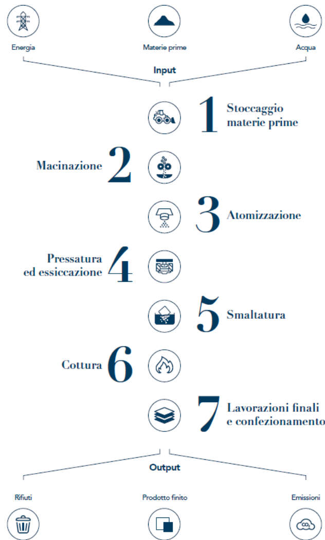
schema processo produttivo
