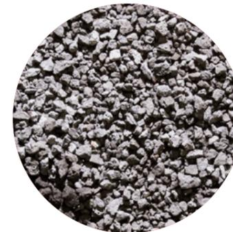
La presente EPD si riferisce all'aggregato artificiale di origine industriale Gripstone, prodotto nello stabilimento Alfa Acciai di Brescia (Italia). I residui di produzione derivanti dal processo del forno ad arco elettrico rappresentano il materiale centrale dell'aggregato. Una volta prodotta e trasformata, attraverso un impianto di frantumazione (primaria e secondaria) e vagliatura la scoria nera diventa Gripstone.
