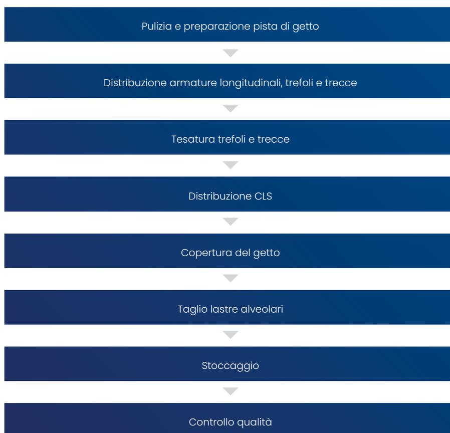
**Figura 4:** Schema ciclo produttivo solaio alveolare prefabbricato "POKER" Manini
