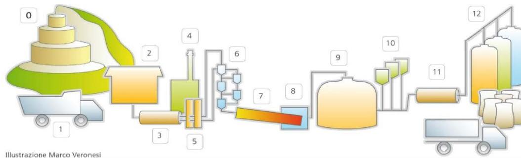
Figura 3. Il ciclo di produzione del cemento
