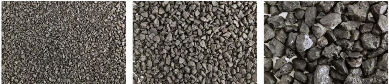
Figura 3: IPERGRIP– Aggregato artificiale in diverse pezzature.
