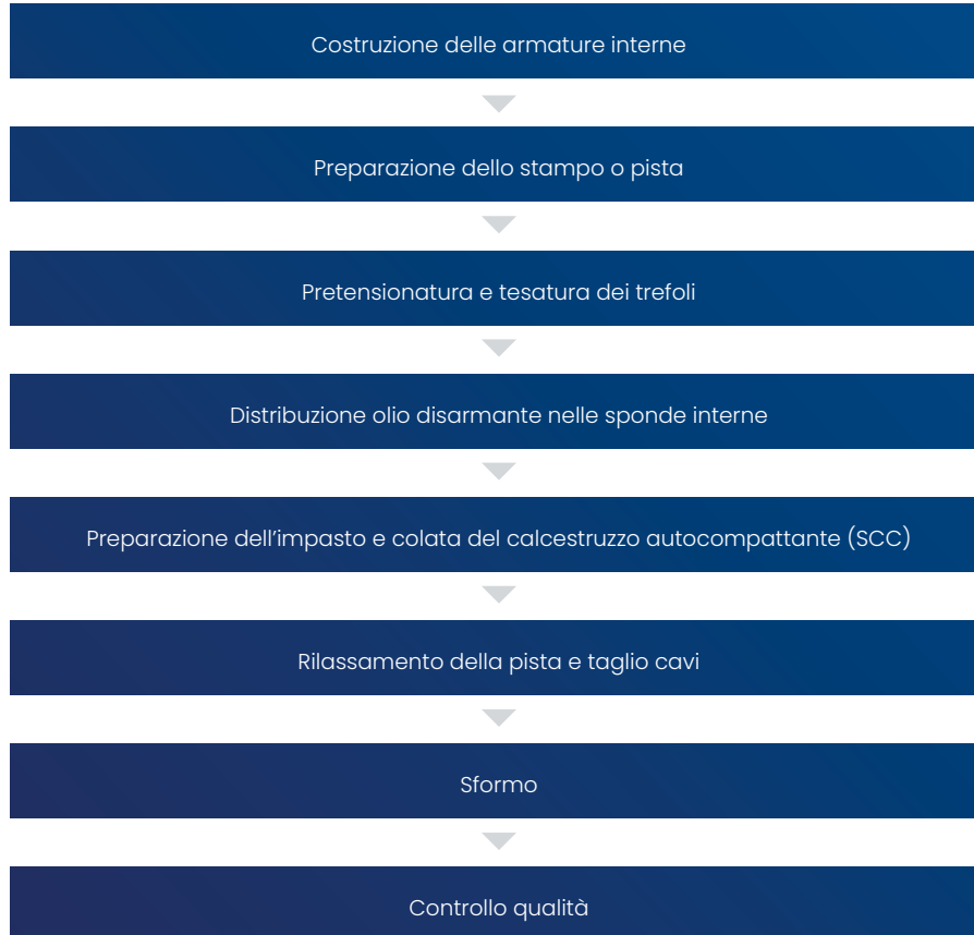
Figura 3: Schema ciclo produttivo trave prefabbricata
