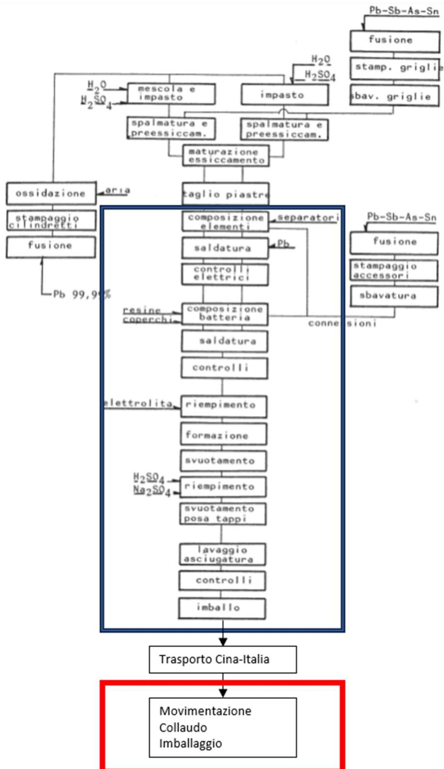
Figura 2: Schema del ciclo produttivo batteria di FIB FH 12-33 (in blu i confini aziendali del sito di Hengyang ed in rosso quelli dello stabilimento di Monterubbiano).
